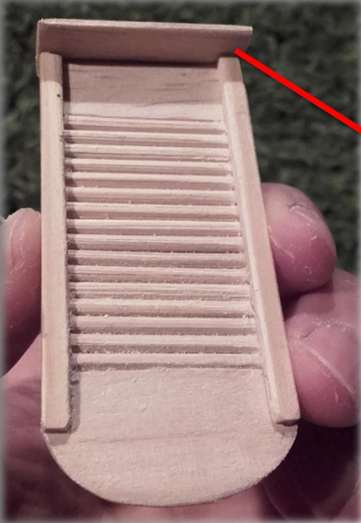
**En la parte superior medimos anchura total de la tabla, y con una anchura suficiente para que quede enrasado por la parte trasera y sobresalga por la delantera**
