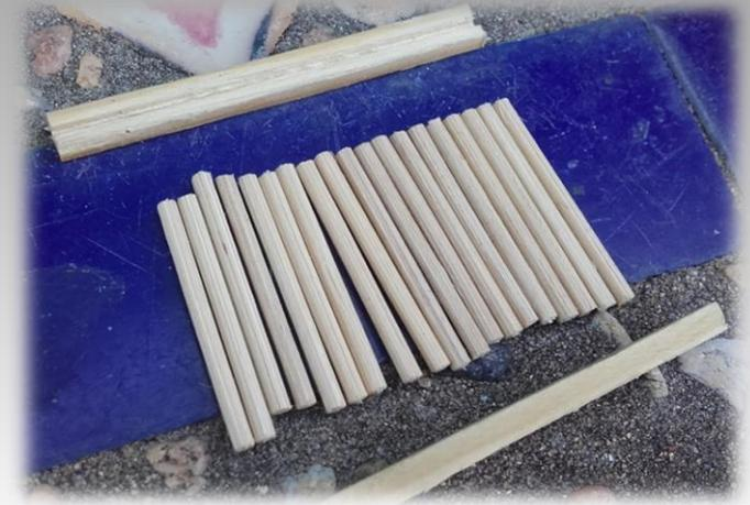
**Usando una sierra o la multiherramienta dremel, realizamos una acanaladura longitudinal en cada listón de la anchura del diámetro de la varilla, donde encajarán las varillas.**
