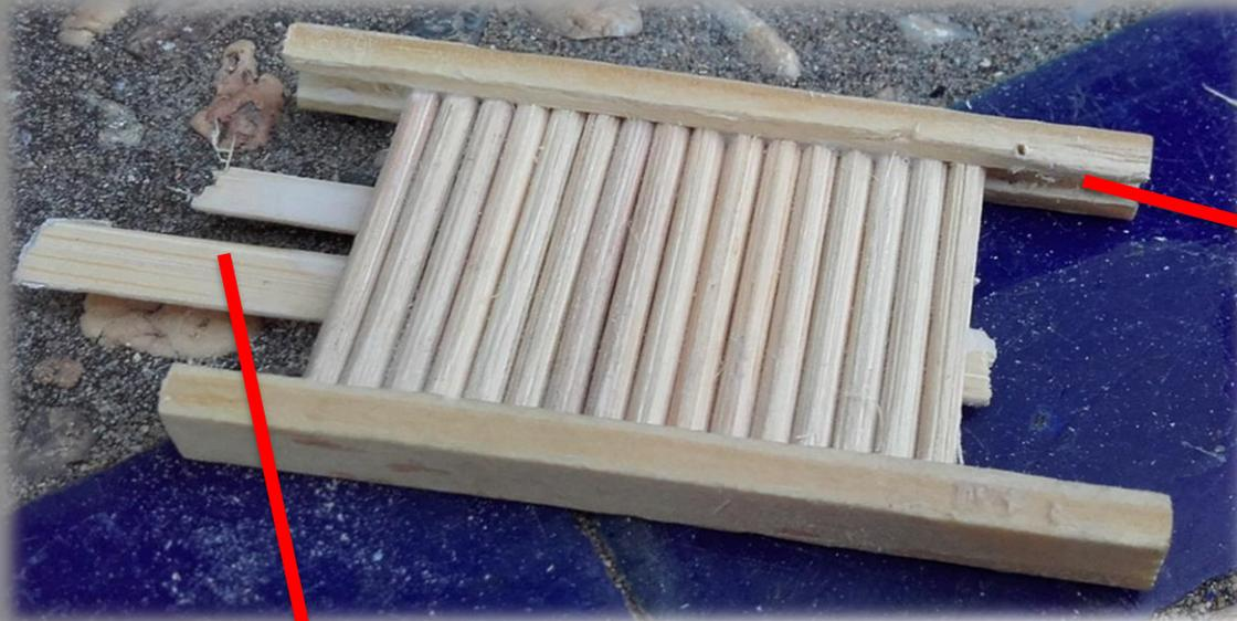
**Fijamos con cola las varillas en las acanaladuras de los listones. Dejando una parte a cada lado sin varillas.**
