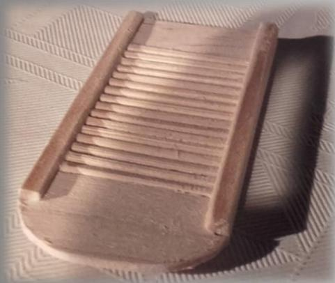
**Por la parte trasera de la tabla de lavar retiramos con un cúter las tablillas de fijación que colocamos al principio**
