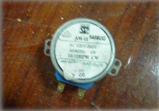
Para darle movimiento al columpio, utilizaremos un motor de baja revolución de 10/12 rpm .
