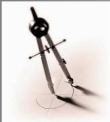
Es nuestra herramienta perfecta para la realización de arcos y elementos circulares. Para marcar en el porex, utilizaremos un adaptador en su punta que sujeta nuestro rotulador indeleble o para plásticos.
