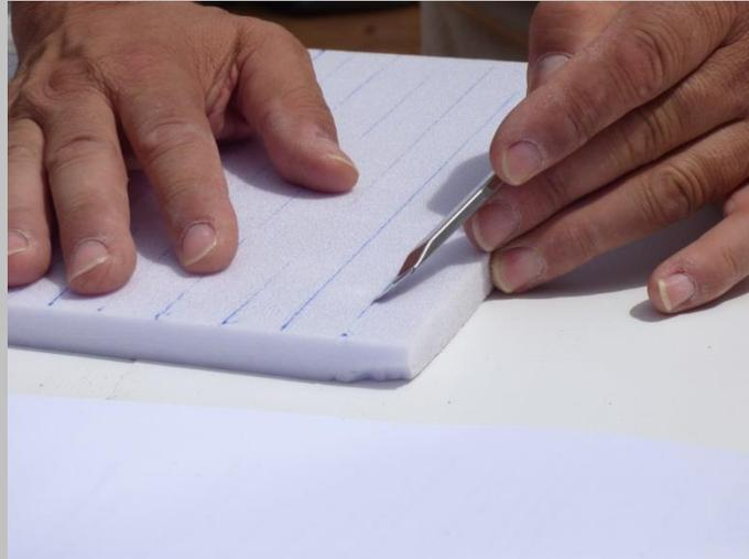
Realizadas las divisiones de nuestros tabloncillos, empezamos a realizar incisiones con la ayuda de un cúter de hoja fina con el cúter inclinado. Primero realizaremos por un lado de la línea marcada y después por el otro lado de la línea de la misma manera, quedando la forma cortada de cuña (muestra en la fotografía anterior).
