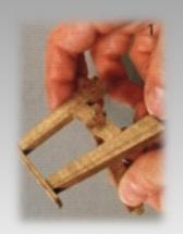
Pegamos en la parte superior de las patas, las piezas (A) que sirven para reforzar, y marcamos las líneas de colocación en la parte de abajo de la mesa para luego pegar las patas en este lugar.
